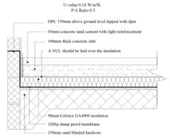
**SOLID FLOOR INSULATION UNDER SLAB**
